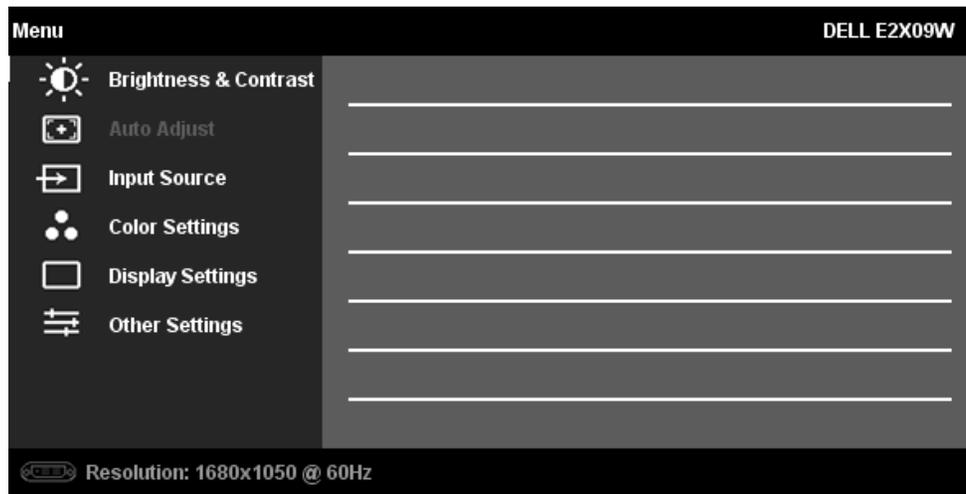
**NOTA:** La funzione di REGOLAZIONE AUTOMATICA è disponibile solo quando si usa il connettore analogico (VGA).
